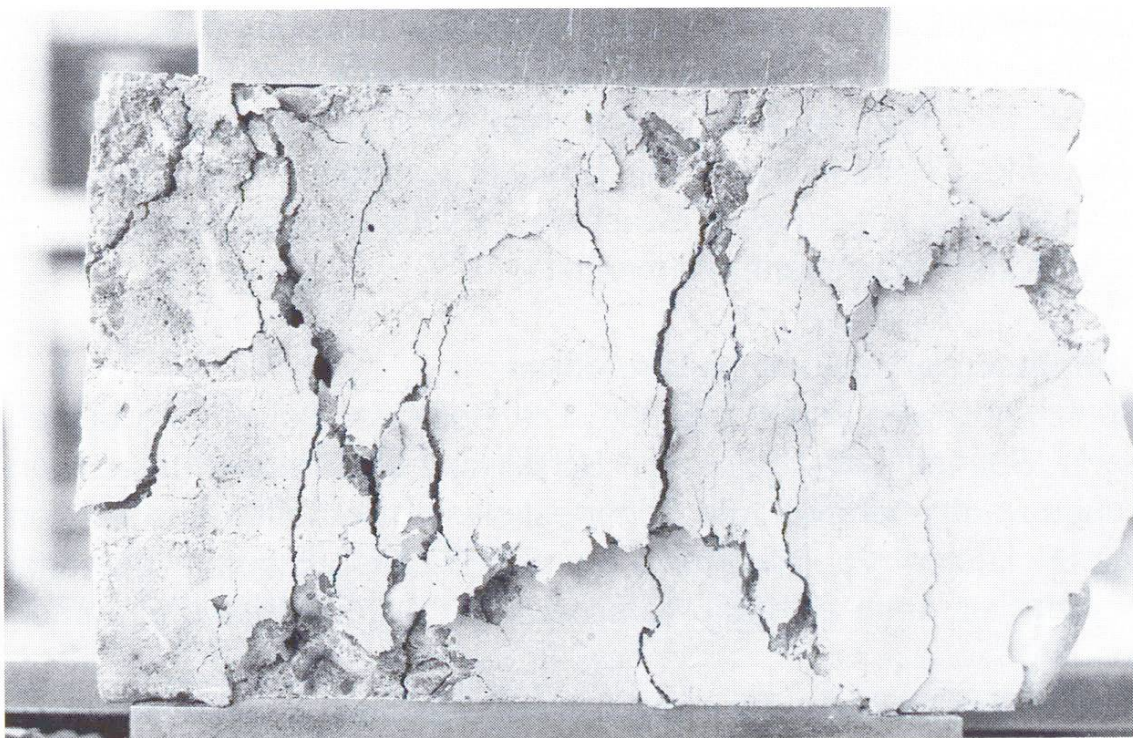
Abb. 2. Stahlfaserbeton bricht bei Druckbelastung nach dem Auftreten von Rissen nicht sofort auseinander. (Fotos: TFB)
