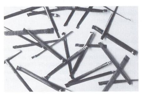
Abb. 4 Gefräste Stahlfasern mit Endverankerungen (Länge: 32 mm).
