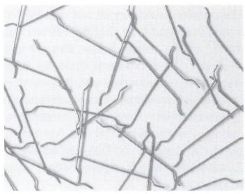
Abb. 7. Flache Fasern mit abgewinkelten Enden (30×0,5 mm).
