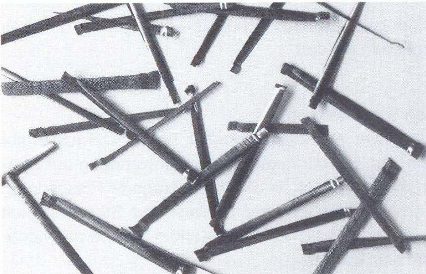
Abb. 4 Gefräste Stahlfasern mit Endverankerungen (Länge: 32 mm).
