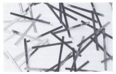
Abb. 3. Glatte Fasern (Länge: 20 mm, Breite: 1,0 mm).
