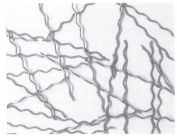
Abb. 6. Runde, gewellte Fasern  $(60 \times 1 \text{ mm})$ .
