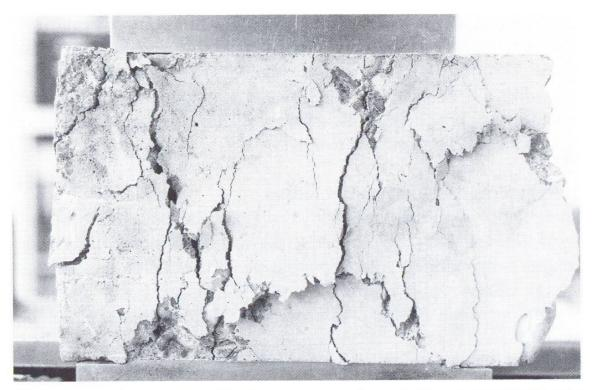
Abb. 2. Stahlfaserbeton bricht bei Druckbelastung nach dem Auftreten von Rissen nicht sofort auseinander. (Fotos: TFB)
