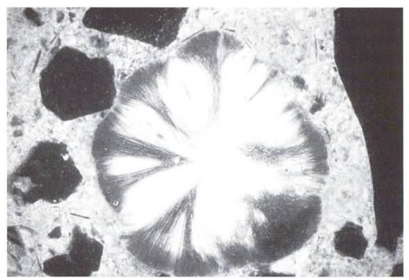
Mit Ettringit gefüllter Hohlraum in carbonatisiertem Zementstein (Aufnahme unter Fluoreszenzlicht, Ausschnittgrösse 0,72 × 1,08 mm). (Foto: TFB, Vernier)
