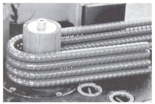
Zu den zahlreichen Qualitätsüberwachungen der beschichteten Betonstähle gehört auch die Kontrolle der Biegefähigkeit um einen Biegedorn mit vier- oder sechsfachem Stabdurchmesser. Die Abwesenheit von Rissen ist ein Beweis dafür, dass die Beschichtung gut haftet.
