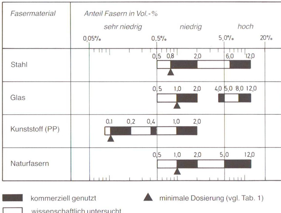
Abb. 2 Technische Arbeitsbereiche mit verschiedenen Fasern, gemessen am Gehalt im fertigen Produkt (in Vol.-%). Darstellung im logarithmischen Massstab gemäss [3].
