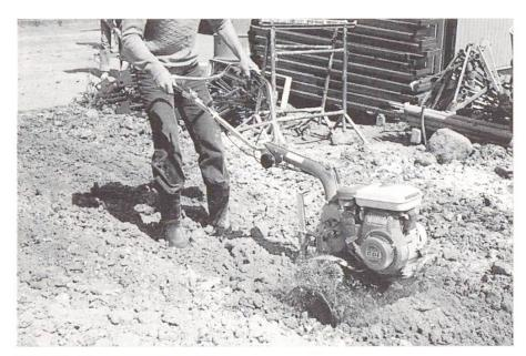
Abb. 12 Mischen mit Bodenfräse
