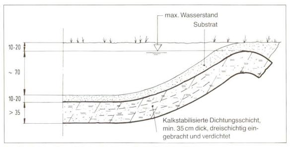
Abb. 5 Weiheraufbau mit Kalkstabilisierung. Detail Randabschluss
