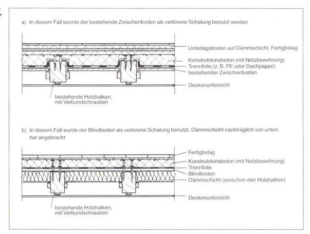
Abb. 2 Aufbau einer verstärkten Holzbalkendecke
