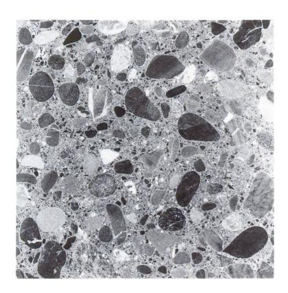
Abb. 8 b Betonstruktur zur Siebkurve D (Sägeschnitt)
