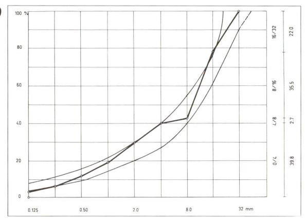
Abb. 8a Versuchsmischung D. Sieblinie mit Ausfallkörnung. Die Korngruppe 4/8 wurde nicht beigemischt. Die trotzdem vorhandenen Körner zwischen 4 und 8 mm sind Über- oder Unterkorn der anderen Korngruppen
