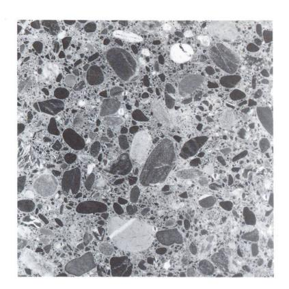
Abb. 6 b Betonstruktur zur Siebkurve B (Sägeschnitt)
