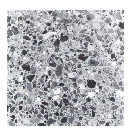
Abb. 9 b Betonstruktur zur Siebkurve E (Sägeschnitt)
