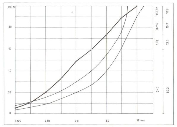
Abb. 7 a Versuchsmischung C. Sandreiche Mischung, die ausserhalb des empfohlenen Sieblinienbereichs liegt
