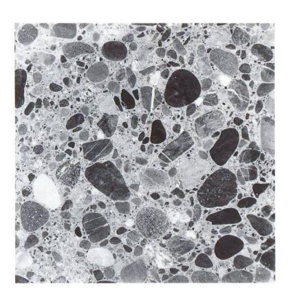
Abb. 5 b Betonstruktur zur Siebkurve A (Sägeschnitt)
