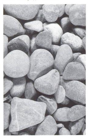
Die Kornform beeinflusst die Verarbeitbarkeit bzw. die Rohdichte des Betons. Runde und gerundete Körner lassen sich gut verdichten. Flache und stengelige lassen sich weniger kompakt lagern, brauchen also mehr Feinanteile für die vollkommene Verdichtung. Neben diesen natürlichen Zuschlägen werden auch gebrochene verwendet, was Verarbeitbarkeit und Festigkeit beeinflusst.
