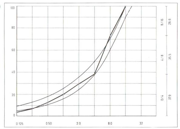
Abb. 9 a Versuchsmischung E. Stetige Sieblinie für einen Grösstkorndurchmesser von 16 mm. Der Sieblinienbereich ist für dieses Grösstkorn nicht mehr normiert. Als Vergleich ist der Sieblinienbereich mit den Formeln gemäss Norm SIA 162 (1968) eingezeichnet
