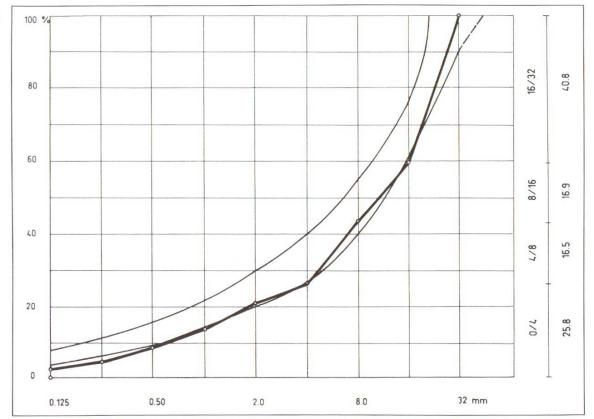
Abb. 5 a Versuchsmischung A. Stetige Sieblinie mit geringem Sandanteil. Abszisse: Siebdurchmesser. Ordinate: Siebdurchgang in Masse -%. Eingezeichnet ist ausserdem der Sieblinienbereich gemäss Norm SIA 162 (1989)
