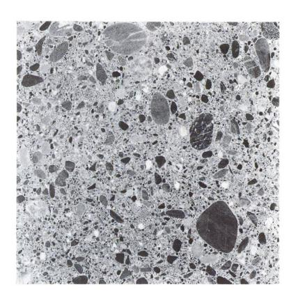
Abb. 7 b Betonstruktur zur Siebkurve C (Sägeschnitt)
