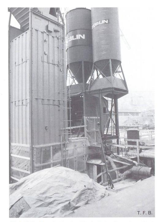
Abb. 2 Mobile Anlage, bestehend aus Kiessilo, Mischer, Zementsilo und Silo für Zusatzstoffe. Die Tanks mit den Zusatzmitteln sind in der Stahlkonstruktion unterhalb des Mischers aufgestellt.
