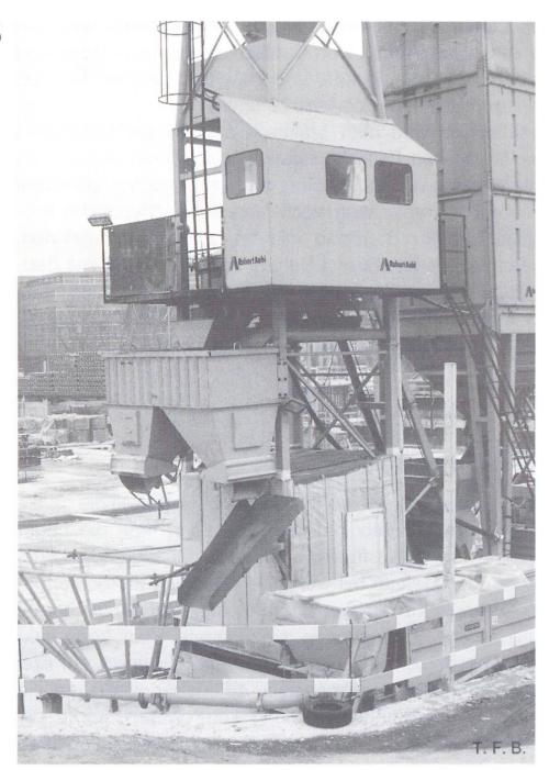
Abb. 1 Mobile Anlage zur Herstellung von Baustellenbeton, bestehend aus Mischer, Kiessilo (rechts) und Zementsilo (aufgehend, nicht sichtbar). Abgabetrichter mit zwei Schnauzen zur Förderung mit Kübel (links) bzw. Pumpe (rechts). Der Mischer ruht auf einer Stahlkonstruktion, die gleichzeitig als Lager für die Zusatzmittel dient. In diesem Beispiel sind ebenerdig zwei Tanks aufgestellt. Die aufgehenden Stahlprofile wurden behelfsmässig zu einer Hütte verschalt und isoliert.
