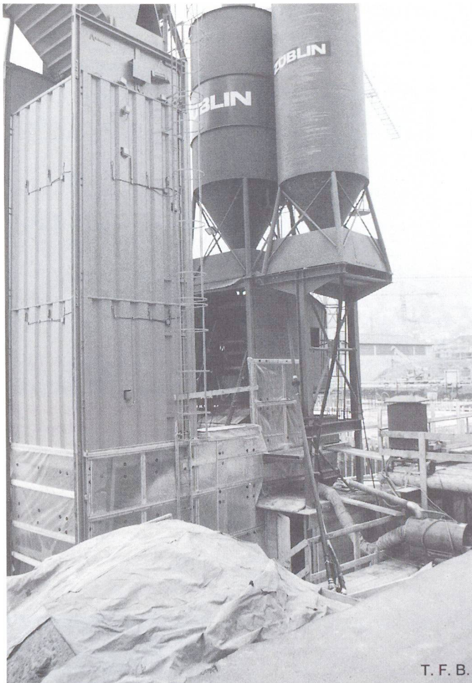
Abb. 2 Mobile Anlage, bestehend aus Kiessilo, Mischer, Zementsilo und Silo für Zusatzstoffe. Die Tanks mit den Zusatzmitteln sind in der Stahlkonstruktion unterhalb des Mixers aufgestellt.
