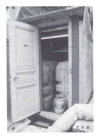
Abb. 4 Verschaltes und isoliertes Lager für die Tanks mit Zusatzmitteln, in der Stahlkonstruktion des Mischers untergebracht und dauernd beheizt.
