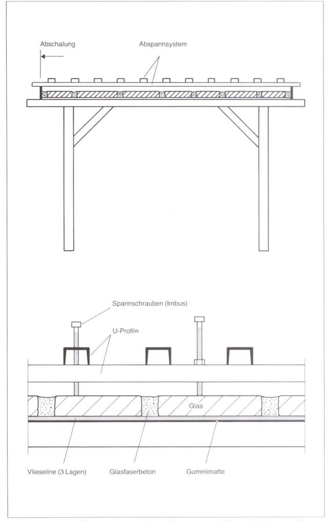
Abb. 4 Arbeitstisch zur Rekonstruktion der Fensterteile von  $1 \times 1$  m. Aufbau der Unterlage und Abspannsystem. Die U-Profile werden seitlich mit Schraubzwingen befestigt und in der Mitte gegen das Dach des Ateliers verspriesst.
