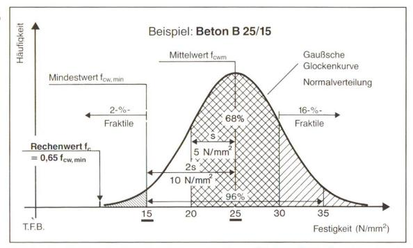
Abb. 2 Klassifikation der Betonfestigkeit gemäss Norm SIA 162 (1989). Grundlage für das Beispiel: Resultate der Prüfserie eines Betons B 25/15.
