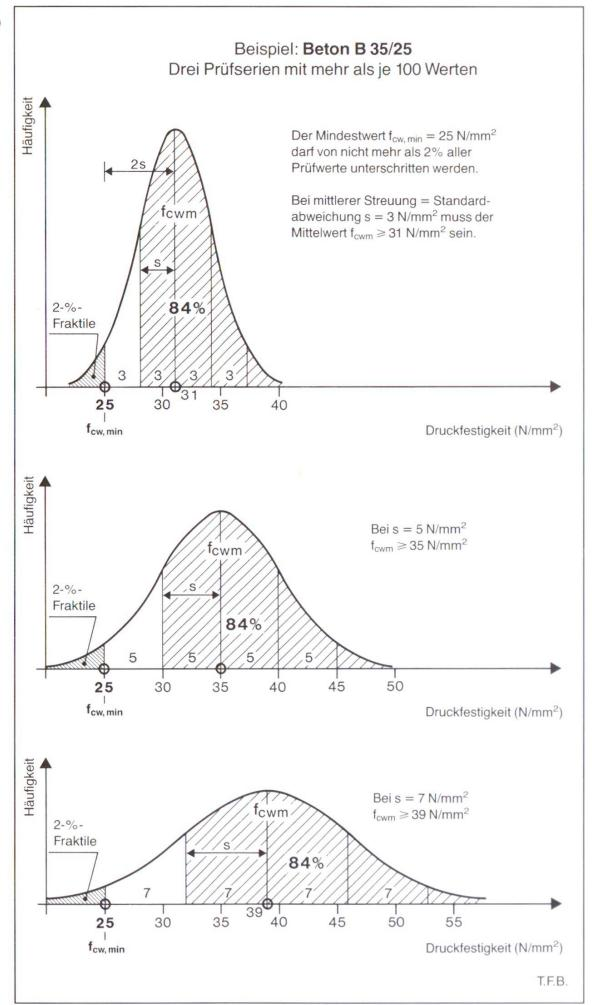
Abb. 3 Laufende Kontrolle an einem Beton B 35/25: drei verschiedene Prüfserien mit unterschiedlicher Streuung. Einzuhalten ist der Mindestwert. Bei grosser Streuung ist der Mittelwert als Zielgrösse entsprechend höher anzusetzen.
