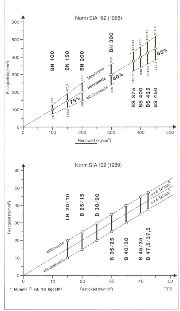
Abb. 5 Die Kennwerte der Betonfestigkeiten gemäss Norm SIA 162 im Vergleich. Oben: Ausgabe 1968, unten: Ausgabe 1989.
