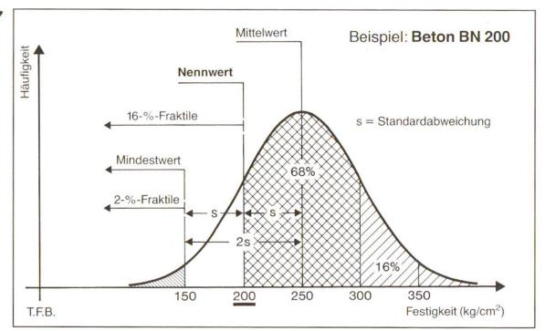
Abb. 4 Klassifikation der Betonfestigkeit gemäss Norm SIA 162 (1968). Grundlage für das Beispiel: Resultate der Prüfserie eines Betons BN 200.
