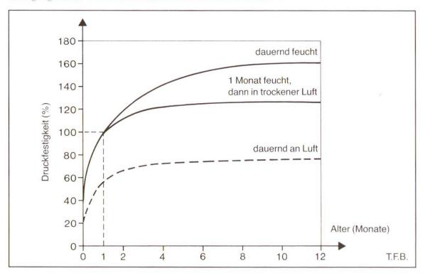
2 sowohl das Alter des Betons als auch die Erhärtungsbedingungen (Betontemperatur, Feuchtigkeit) in Betracht gezogen werden.
