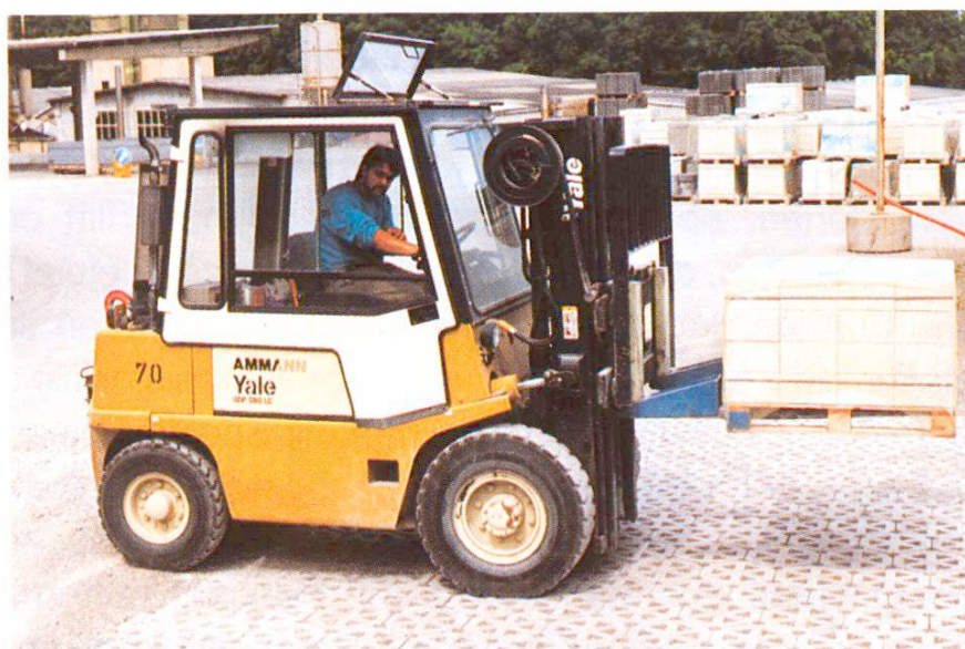
Abb. 10 Spezieller Gitterstein für Lagerplatz.
