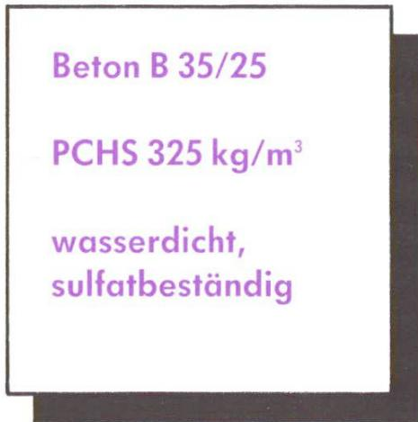
Abb. 1 Bezeichnung des Betons in den Plänen des Ingenieurs. Beispiele für die minimal erforderlichen Angaben.
