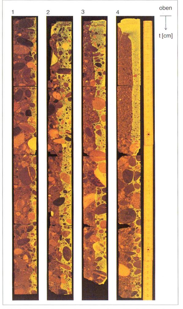
Abb. 2 Probestücke aus dem obern Teil von vier verschiedenen Betonwänden. Betonmischung und Kapillarität, vgl. Tabelle 1.
