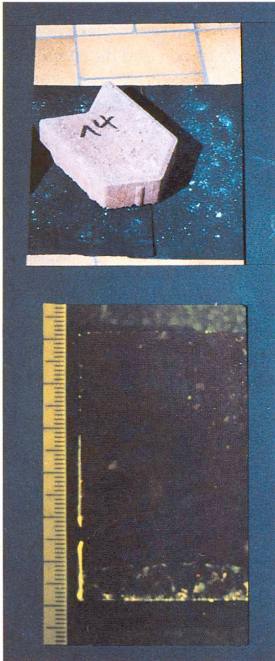
Abb. 4 Pflasterstein ohne Ausblühungen. Wassereindring-Koeffizient B = 10 \cdot 10^{-3} \text{ m h}^{-0,5} .
