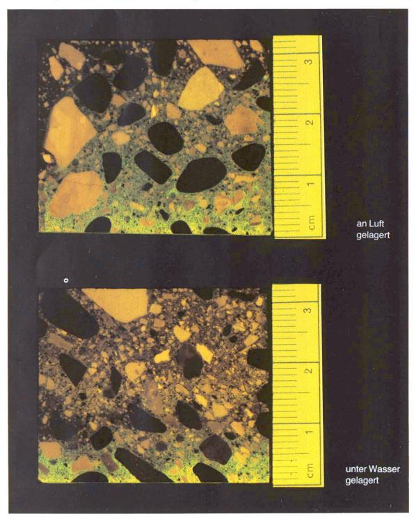
**Beispiel 3.** Ausblühungen können auf Transportphänomene von Wasser innerhalb des Zementsteins zurückgeführt werden. Abb. 4 und 5 zeigen je einen Pflasterstein. Derjenige Stein mit hoher Kapillarität hat auch Ausblühungen (Nr. 13).
