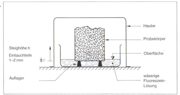
Abb. 1 Versuchseinrichtung zur Bestimmung der Kapillarität.
