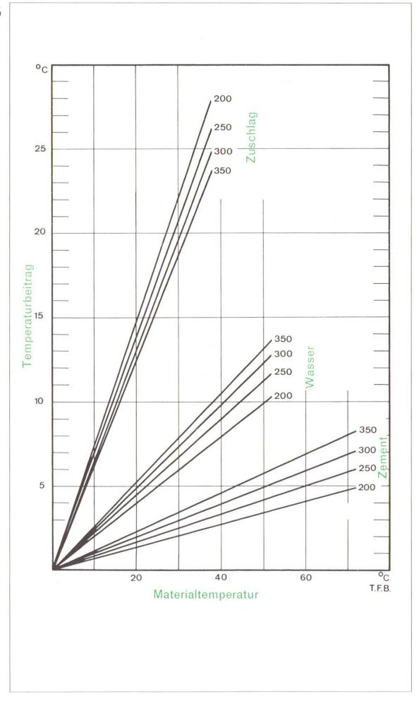
Abb. 1 Diagramm zur Bestimmung der Frischbetontemperatur aus den Temperaturen von Zuschlag, Zement und Anmachwasser bei Zementdosierungen von 200, 250, 300 und 350 kg/m³. Die an der Ordinate herausgelesenen Temperaturbeiträge ergeben zusammengezählt die Temperatur des Frischbetons.
