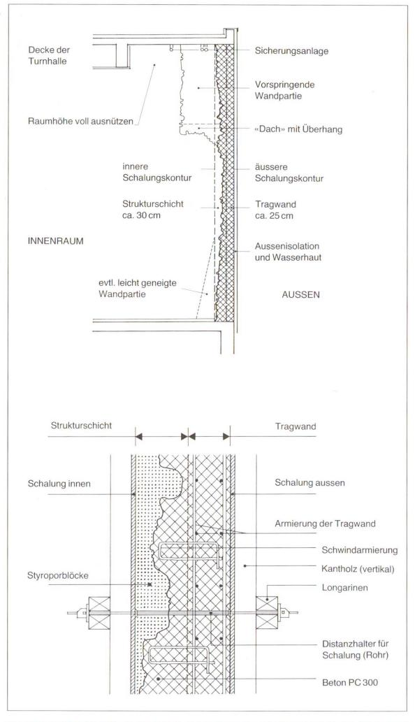
Vorarbeiten: Die architektonische Gestaltung der Wand, der Randpartien und Anschlüsse bilden die Grundlage für die Detail- und Ausführungspläne. Dabei sind die Sicherungsanlagen (Schienen, Rollen, Rohre, Ringe usw.) zweckmässig einzuplanen. Für die Bereinigung der ganzen Konstruktion ist die Zusammenarbeit von Bauingenieur/Statiker, Baumeister, Schalungstechniker und Gestaltungsteam sehr wichtig.
