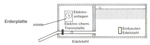
Stahl 37/Zementauskleidung oder duktiler Guss/Zementauskleidung
