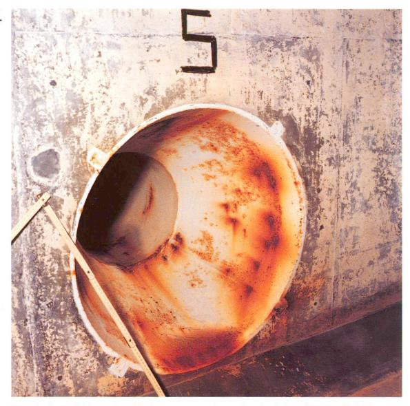
Abb. 3 Auslauftrichter eines Trinkwasserreservoirs nach zehn Jahren Betrieb (St 37 feuerverzinkt mit Kunststoffschutzanstrich).
