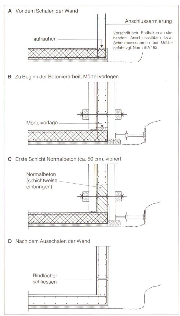
Mischungen mit Grösstkorndurchmesser bis 8 mm werden als Mörtel bezeichnet. Mischungen mit grösserem Grösstkorn nennt man Beton. Statt Mörtelvorlage verwendet man auch die Ausdrücke Vorlegemörtel, Fussmischung, Betonschicht ohne grobes Korn, Feinbeton, Überzugsmörtel, Zementmörtelvorlage.
