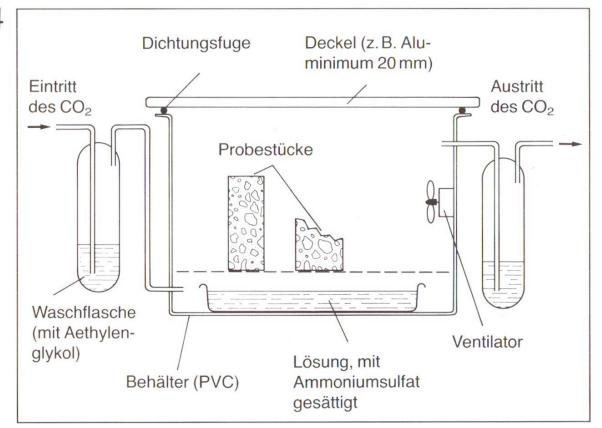
Abb. 1 Ausrüstung zur Durchführung der Versuche.
