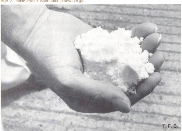
Abb. 2 MHK-Paste. Schüttdichte etwa 75 g/l.
