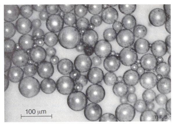
Abb. 1 Mikrohohlkugeln als Betonzusatz. Mikroskopische Aufnahme der MHK-Paste.
