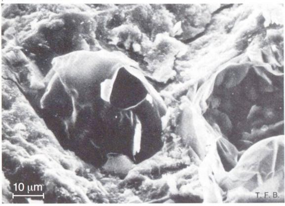
6 Zementstein, der von MHK durchsetzt ist und dessen Kapillarporen von den Luftporen der MHK unterbrochen sind.
