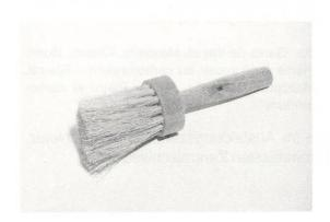
Wasserpinsel. Der Wasserpinsel ist saugfähig und wird im Wasserkessel mitgetragen. Er wird zum Anfeuchten oder Reinigen von Unterlagen gebraucht sowie für die kleine Wasserzugabe zum Frischmörtel.
