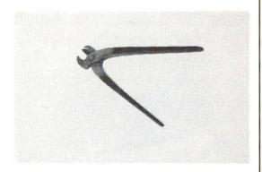
Die **Rabitzzange** ist das Universalwerkzeug des Eisenlegers. Mit seiner scharfen Schneide dient sie zum Öffnen des Eisenbundes (statt mit dem Hammer), zum Abklemmen und Entfernen von Nägeln oder Drähten.
