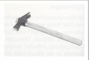
Schalungshammer. Universalwerkzeug für Schalarbeiten. Er dient zum Einschlagen von Nägeln und zum Anziehen oder Lösen der Bindschlösser. Mit der Hammerklaue wird ausgenagelt.
