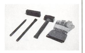
Die Handschuhe werden bei Verletzungsgefahr getragen. Handfäustel, Spitz- und Schlageisen werden für Spitzarbeiten gebraucht. Mit dem Karborundumstein werden Überzähne entfernt sowie Kanten und Betonflächen geschliffen.
