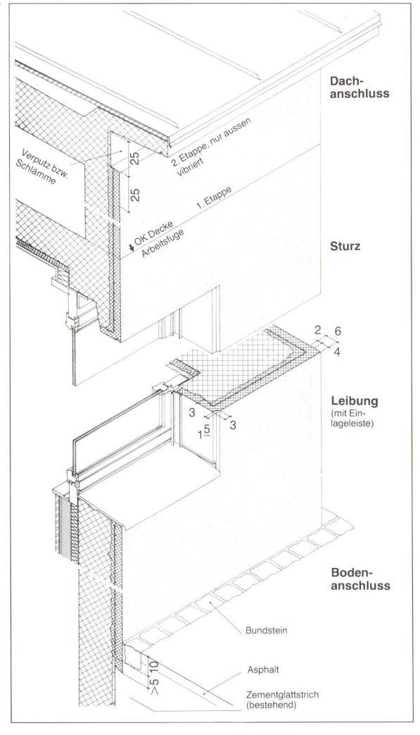
Abb. 2 Sanierung durch Vorbetonieren. Fassadendetails.
