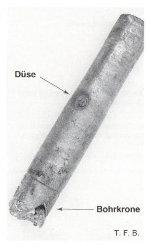
Abb. 3 Bohrkrone und Düse. Der Düsenstrahl tritt senkrecht zur Bohrrichtung aus.
