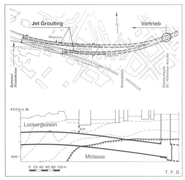
Abb. 4 Zürichbergtunnel der Zürcher S-Bahn, Abzweigung Bahnhof Stadelhofen. Oben: Grundriss der Einspurröhren. Unten: Geologisches Längenprofil (Bergröhre). Der Vortrieb begann im Festgestein der oberen Süsswassermolasse und durchfuhr dann die verschiedenen Moränen und Seeablagerungen. Länge der Abschnitte, die mit Jet Grouting ausgeführt wurden: Bergröhre: 249 m<sup>1</sup>. Seeröhre: 145 m<sup>1</sup>.
