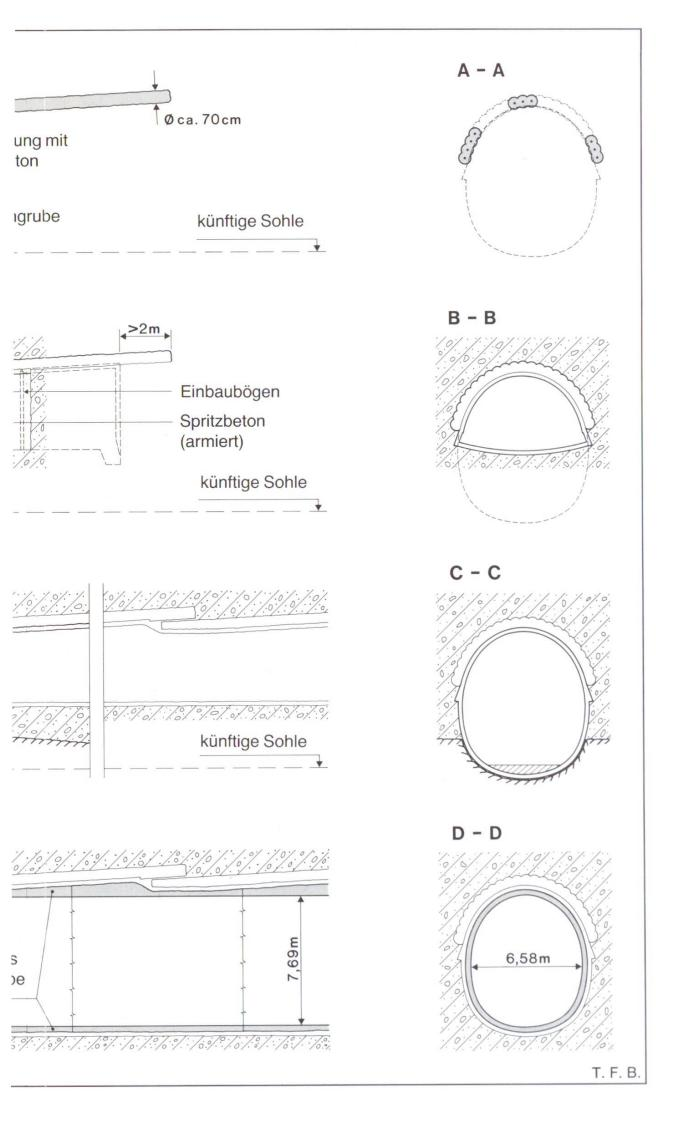
8 konnte nicht im Tagbau gearbeitet werden. Der Aussenring ist in Spritzbetonbauweise ausgeführt und im Teilausbruch (Kalotte, Strosse) erstellt.
