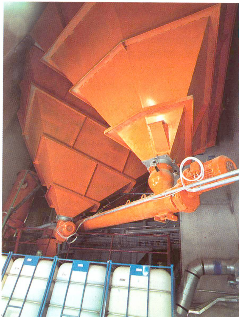
Abb. 8 Zementsilos aus Stahl; Zusatzmittel- tanks.
