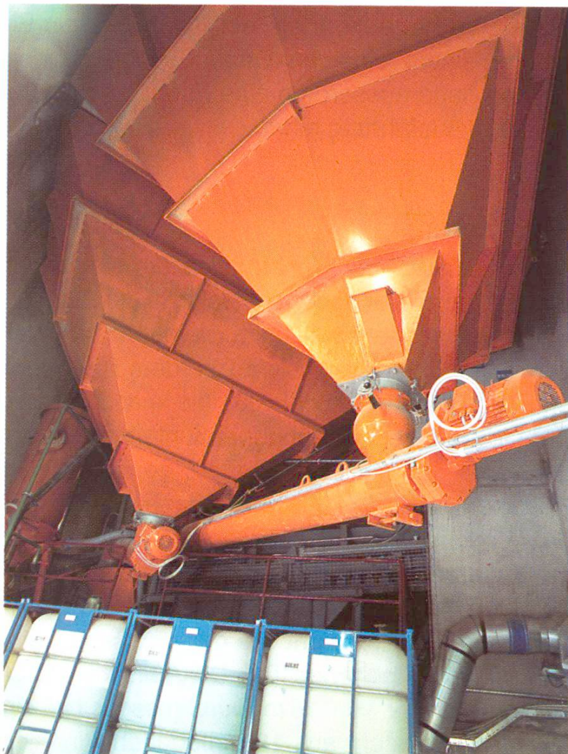
Abb. 8 Zementsilos aus Stahl; Zusatzmittel- tanks.
