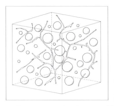
Abb. 1b Idealisiertes Porensystem im Zementstein: Die künstlich eingeführten Luftporen sind kugelförmig und fein verteilt. Sie unterbrechen das Netz der Kapillarporen. Nicht eingezeichnet sind die Gelporen zwischen den Gelteilchen.
