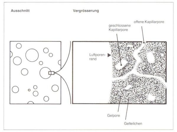
Abb. 1a Zementstein mit künstlich eingeführten Luftporen. Die Vergrösserung rechts zeigt den Luftporenrand, gebildet durch Gelteilchen (Darstellung gemäss T. C. Powers).
