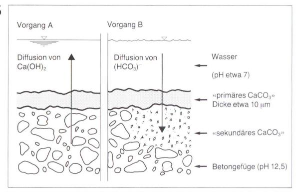
Abb. 4 Diffusionsvorgänge beim Kontakt von Beton mit Wasser. Vorgang A: Im stehenden bzw. reinen Wasser. Vorgang B: Im fliessenden Wasser, das Kohlensäure enthält.
