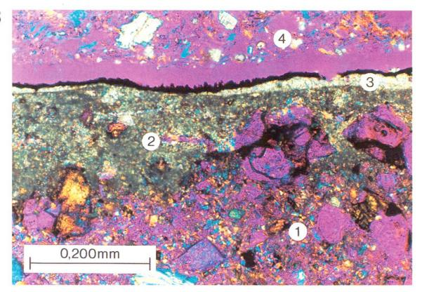
Abb. 2 Dünnschliff durch eine Mörteloberfläche, die während 100 Jahren dem fliessenden Wasser ausgesetzt war (mikroskopische Aufnahme). ① Ursprüngliches Mörtelgefüge. ② Calcit-Einlagerung im Mörtelgefüge («sekundäres CaCO<sub>3</sub>»). ③ Calcit-Schutzschicht («primäres CaCO<sub>3</sub>») mit Ablagerungen. ④ Einbettmasse aus Gips zur Präparierung des Dünnschliffs (an der Stelle des fliessenden Wassers).
