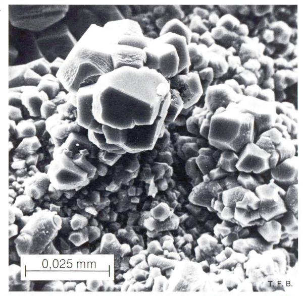
Abb. 3 Calcit-Schutzschicht auf einer Mörtelprobe, die dem fliessenden Wasser ausgesetzt ist (REM-Aufnahme).
