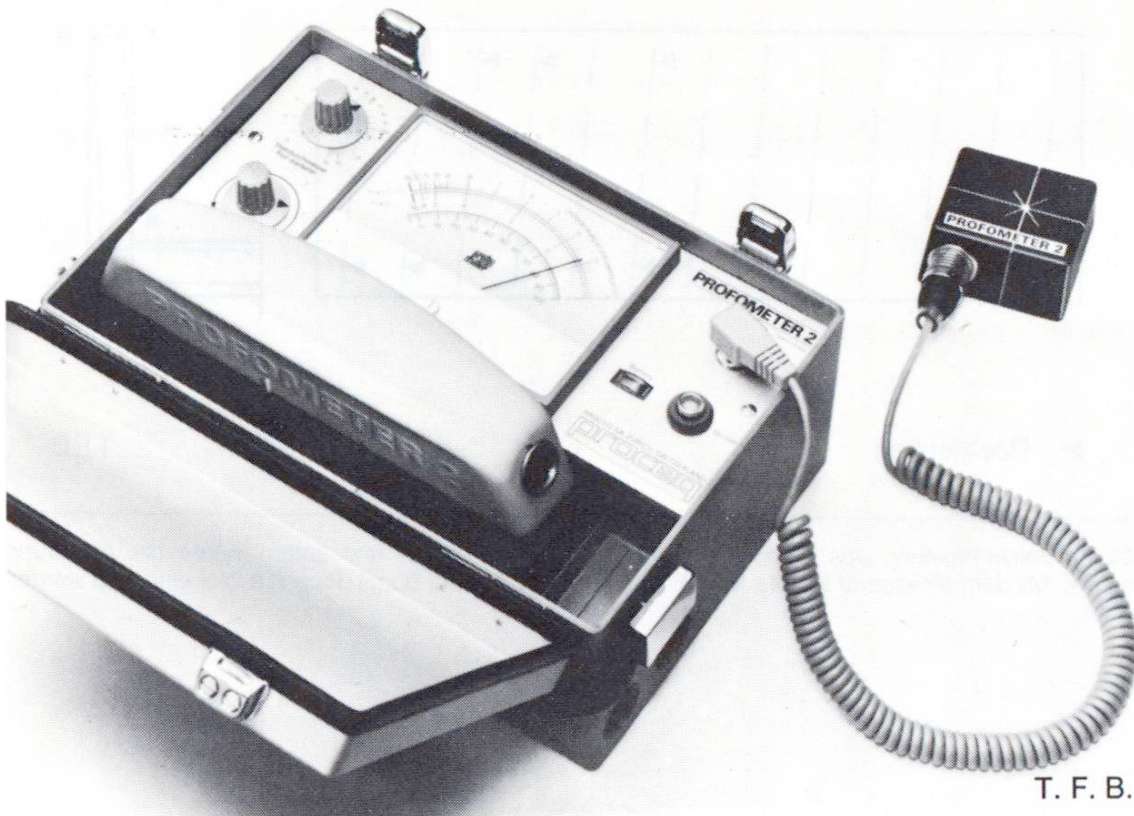
Abb. 1 Elektromagnetisches Armierungssuchgerät. Angeschlossen ist die Punktsonde. Links die beiden Drehknöpfe für die Wahl des Stabdurchmessers und für den «Nullabgleich».
