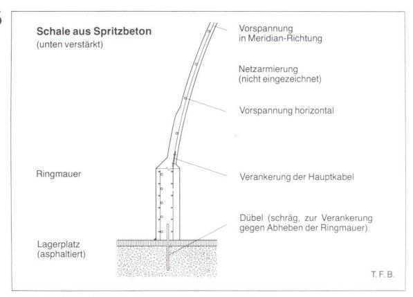
Abb. 3 Fundation, Ringmauer und unterster Teil der Spritzbetonschale.
