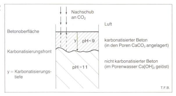
Abb. 1a Aus der Luft diffundiert CO<sub>2</sub> durch die Poren des Zementsteins bis zur Karbonatisierungsfront. Dort bildet sich an den Porenwänden Kalzit (Kalziumkarbonat), das die Poren teilweise füllt. Das Kalziumhydrat wird langsam aufgebraucht, so dass sich die Karbonatisierungsfront ins Betoninnere verschiebt.
