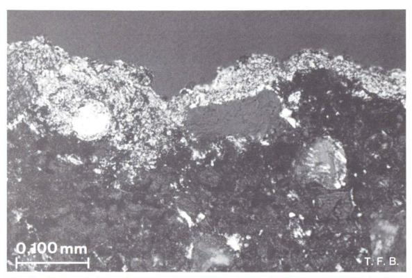
Abb. 1b Beginnende Karbonatisierung auf einer Betonoberfläche (im Mikroskop betrachtet). Die Kalzitschicht ist 50–150  $\mu$ m dick. Im polarisierten Licht erscheint sie hell, während der alkalische Zementstein dunkel bleibt.
