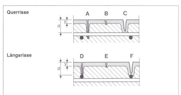
Risse A und D: Armierung in direktem Kontakt mit der Atmosphäre. Korrosion unabhängig von der Karbonatisierung.
