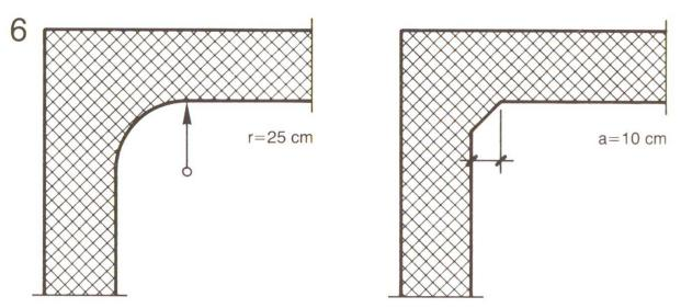
Abb. 5 Ecke Wand/Wand (Grundriss). Ausrundung oder Dreieckleiste.
