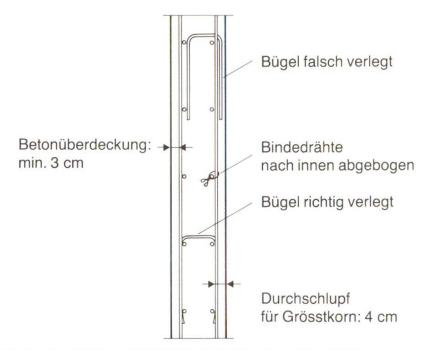
Abb. 6 Wandarmierung (Querschnitt). Stehende Eisen aussen, liegende innen.
