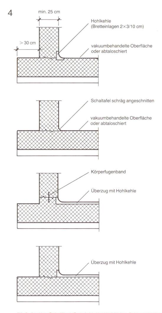
Abb. 2 Anschluss Boden/Wand (Querschnitt). Vier Möglichkeiten. Dichtungsanstrich bei allen Fugen oder Kunststoffzusatz im Vorlagemörtel.
