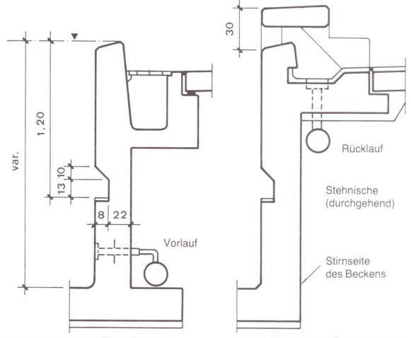
Abb. 3 Beckenrand mit Überfallkante und Stehnische (Querschnitt).
