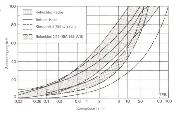
Abb. 1 Kornverteilungsbereiche von Kehrichtschlacke, Kiessand II und Betonkies. Die Kehrichtschlacke entspricht einem Kiessand II und ist erheblich feiner als Betonkies.
