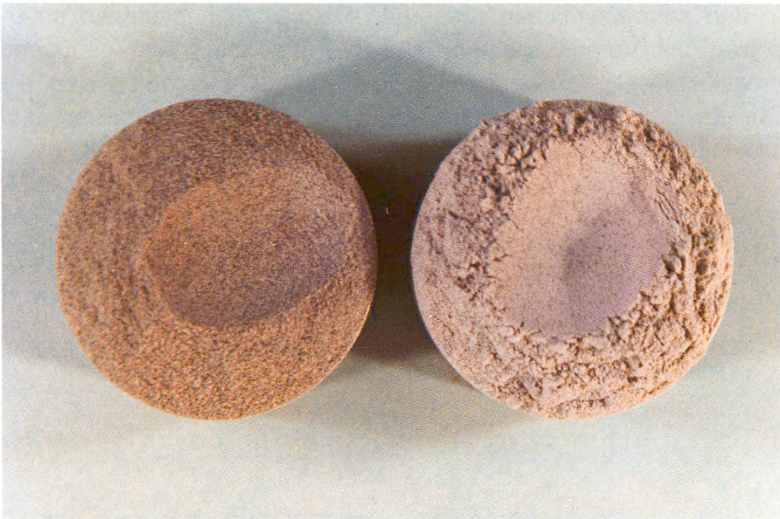
Abb. 2a Feinstanteil \varnothing < 0,1 mm von zwei verschiedenen Sanden. Durchmesser der Proben: 35 mm Glatzstrich mit Löffel. Links: Feinstanteil mit körnigem Aussehen, entsprechend Siebkurve A. Rechts: Feinstanteil ohne erkennbare Körner, entsprechend Siebkurve B.
