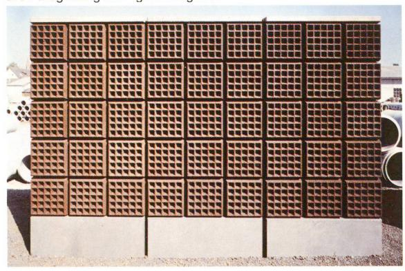
Abb. 9 Faverit-W. Lärmschutzwand aus tragenden, vertikalen Winkelelementen ohne Metallstützen. Gesamthöhe: max. 620 cm, inkl. Fundament. Elementbreite: 100–150 cm. Vertikales Dichtungsband aus Schaumstoff. (Werkphoto)
