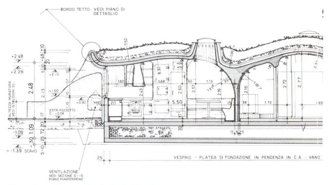
Abb. 7 Querschnitt eines erdüberdeckten Spritzbetonhauses.
