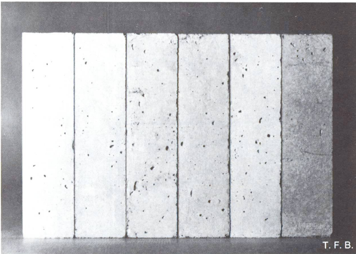
Abb. 5 Prismen aus identischem Beton nach 12 Std. ausgeschalt und 2½ Tage unter verschiedenen Bedingungen gelagert, und zwar: 20/98, 20/80, 20/70, 20/60, 20/75, 3/75, von links nach rechts (Lufttemperatur in °C/relative Luftfeuchtigkeit).
