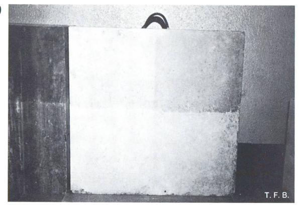
Abb. 6 Betonplatte mit vier verschiedenen Grautönungen. Unten: Beton mit Wasserzementwert = 0.55, oben mit Wasserzementwert = 0,48. Links: langsame Austrocknung, 3 Tage abgedeckt; rechts: 3 Tage offene Lagerung mit Luftzug.
