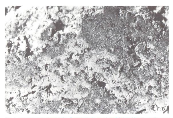
Abb. 1 Vergrösserte Wiedergabe einer Betonoberfläche aus glatter Schalung. Man erkennt eine stark heterogene Struktur infolge kleinräumiger Entmischungen: milchglasähnlicher Zementstein mit verschiedenen Tönungen infolge Wassergehaltsverschiebungen – Sandkörner – Reste unhydratisierten Zements – kleine Agglomerate von ausgeschiedenem Kalk. Auch Grobporen tragen als schwarze Punkte zum Grauton bei. Die Bildbreite entspricht ungefähr 10 mm.
