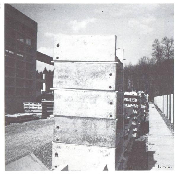
Abb. 4 Gleiche Elemente – ungleiche Betonzusammensetzung
