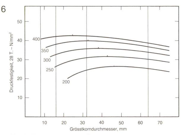
Abb. 3 Die Zementdosierungen 200–400 kg/m³ der plastischen Betonmischungen gemäss Abb. 2. Es zeigen sich Festigkeitshöchstwerte bei bestimmten Zementdosierungen und Grösstkorndurchmessern. Mit höherem Zementgehalt liegen die Optima beim kleineren Grösstkorn. S. auch «CB», Nrn. 14 und 21/1965).
