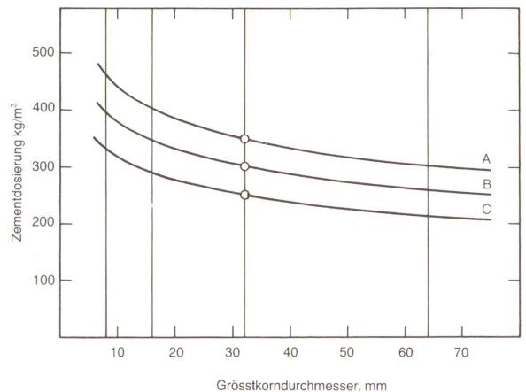
Abb. 1 Wenn man Betone mit sonst ähnlichen Eigenschaften vergleicht, so folgt die Zementdosierung P dem Grösstkorn D ungefähr nach der Formel
