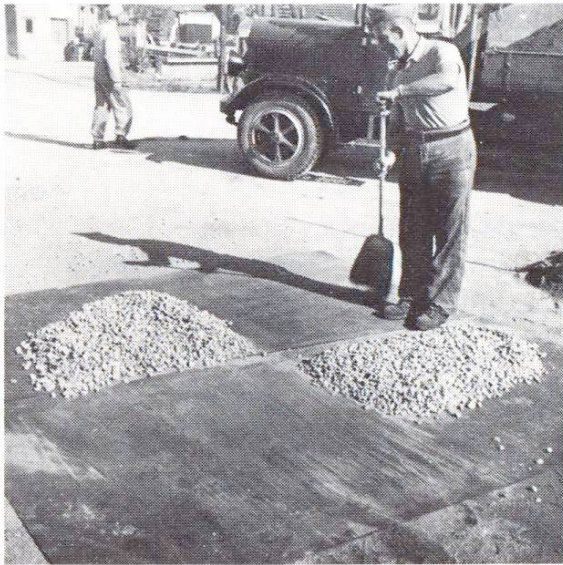
Abb. 5–8 Probenteilung nach der Vierteilmethode.
