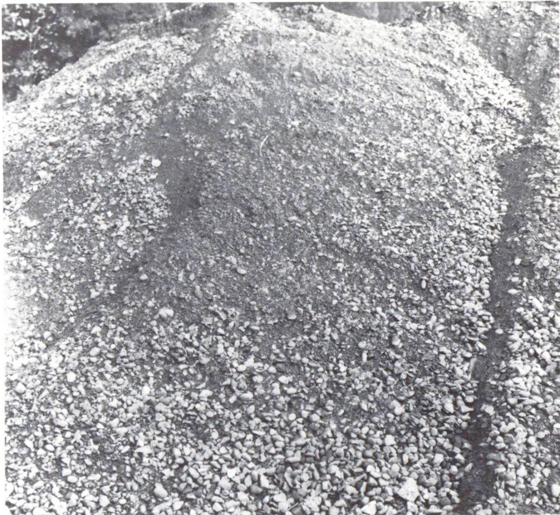
Abb. 3 Korngrößenentmischung am Depothaufen.
