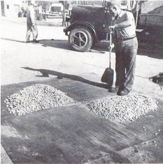
Abb. 5–8 Probenteilung nach der Viertelmethode.
