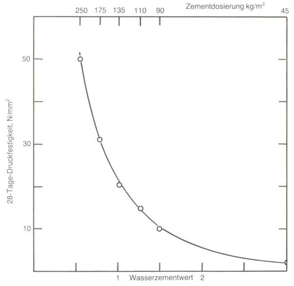
Abb. 2 Druckfestigkeit von Magerbetons in Abhängigkeit vom Wasserzementwert bzw. von der Zementdosierung. Nach Williams (1).
