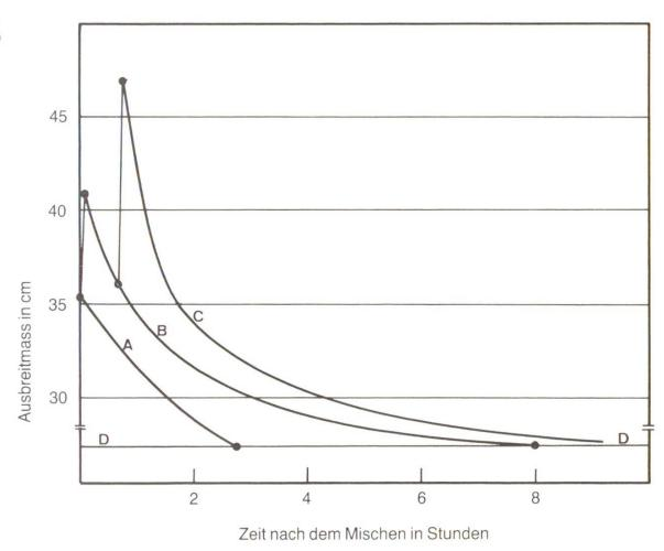
die Wirkung mit Zementen verschiedener Herkunft und die Wirkung bei kombinierter Anwendung mit Verflüssigern.
