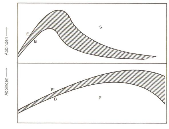
Abb. 2 Schematische Darstellung der typischen Wirkung eines Verzögerers vom Typ «Saccharose» (S) und Typ «Phosphat» (P) auf das Abbinden von Zement. Kurven B = Abbindebeginn, Kurven E = Abbindeende, schraffiert = Liegezeit (nach Kern, s. Literaturangabe).
