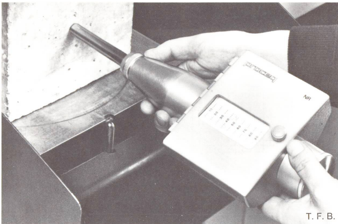
Abb. 4 Betonprüfhammer «Schmidt», Modell NR, wird in einem Betonwerk auf die dort verwendete Betonqualität geeicht.
