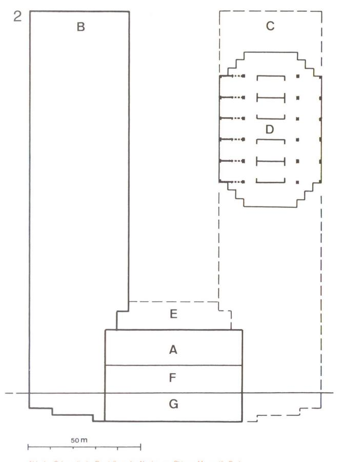
Abb. 1 Schematische Darstellung des Neubaues «Chicago Mercantile Exchange». A - Grosser Börsensaal, stützenfrei, 3700 m²
