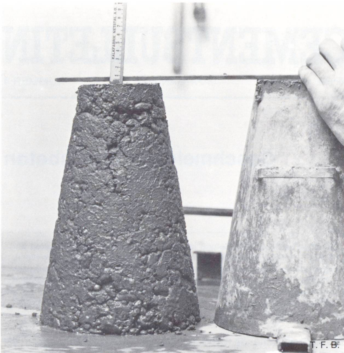
Abb. 1 Setzmass-(Slump-)Test eines steifen Betons mit sandarmem Zuschlag. Man erkennt die Tendenz zur Entmischung und zur Gefahr der mangelhaften Verdichtung – ungünstig im Hinblick auf die Dauerhaftigkeit.
