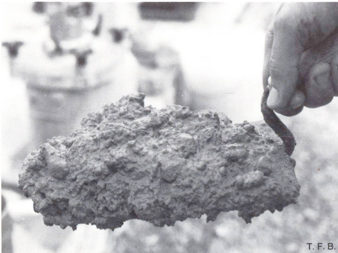
Abb. 2 Mörtelreiche, schwach fliessfähige Betonmischung, die kaum Entmischungstendenzen zeigt.
