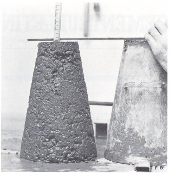
Abb. 1 Setzmass-(Slump-)Test eines steifen Betons mit sandarmem Zuschlag. Man erkennt die Tendenz zur Entmischung und zur Gefahr der mangelhaften Verdichtung – ungünstig im Hinblick auf die Dauerhaftigkeit.
