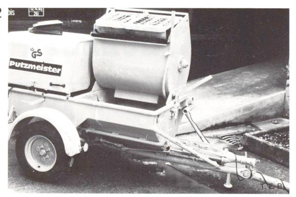
Abb. 2 Schneckenpumpe P 11 zum Mischen und Fördern.
