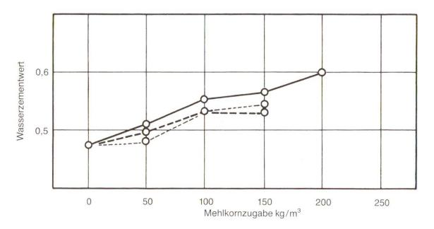
Abb. 2 Wasserzementwerte der weichplastisch eingestellten Betonmischungen gemäss Abb. 1.
