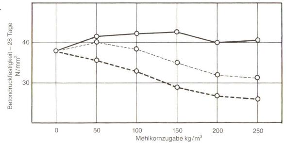
Abb. 1 Betondruckfestigkeit bei verschiedenen Mehlkornzugaben. Nullmischung PC 300, 0-32 mm,
