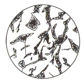
Abb. 1 Schematische Darstellung der Kapillarporen im Zementstein (Bilddurchmesser ca. 0,005 mm). *Links:* W/Z 0.45, Kapillarporenanteil ca. 10 Vol.-%. Die Hohlräume sind nur über Gelporen miteinander verbunden (punktiert angedeutet). *Rechts:* W/Z 0.8, Kapillarporenanteil ca. 40 Vol.-%. Die Hohlräume bilden ein verbundenes System.
