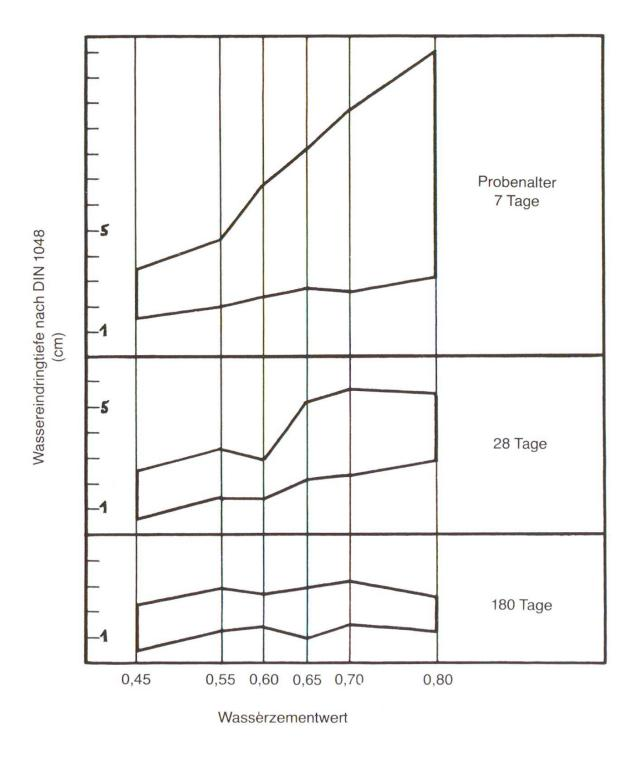
Diese Beobachtungen stehen im Einklang mit der Annahme, dass sich die Kapillarporen bei der Erhärtung zunehmend mit Festsubstanz füllen und später auch Kalkausscheidungen hinzukommen. Der zweite Vorgang bedarf der Anwesenheit von Wasser im Kapillarporensystem.
