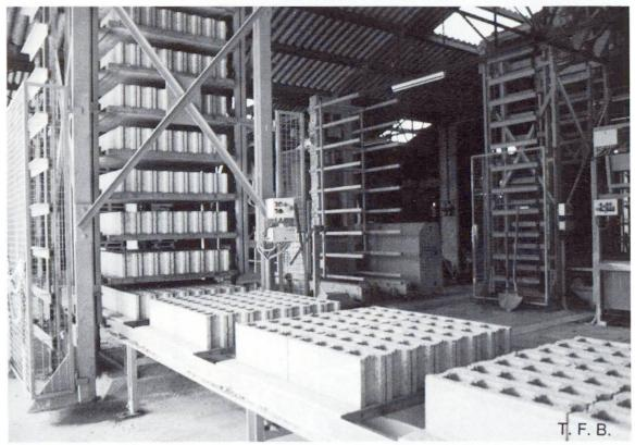
Abb. 15 Produktion von Beton-Mauersteinen mit modernen Maschinen.
