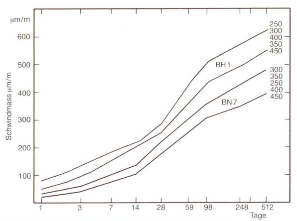
Abb. 1 Aufzeichnung der Schwindmasse von zwei verschiedenen Versuchsreihen.
