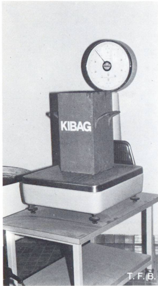
Bestimmung der Frischbeton-Rohdichte
