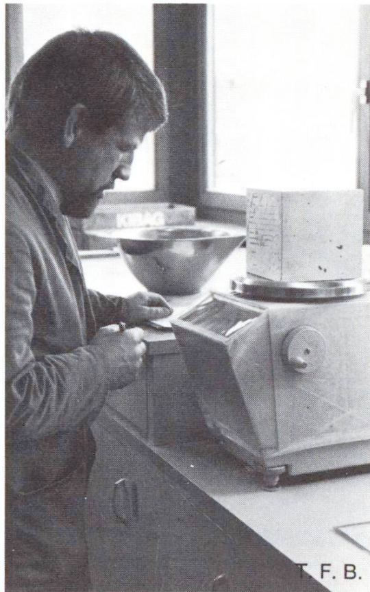
Bestimmung der Rohdichte des erhärteten Betons
