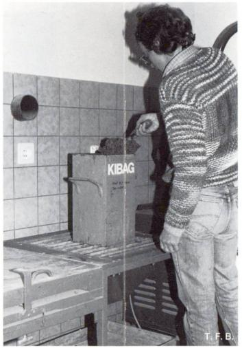
Verdichtungsmass: Füllen des Normalbehälters
