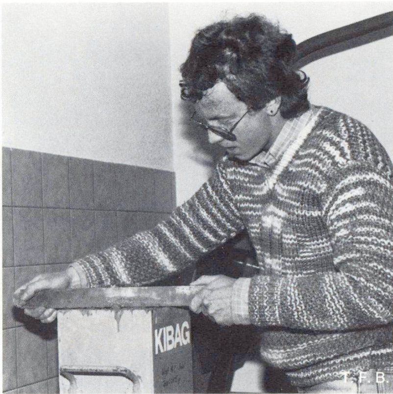
Verdichtungsmass: Abziehen des gefüllten Behälters
