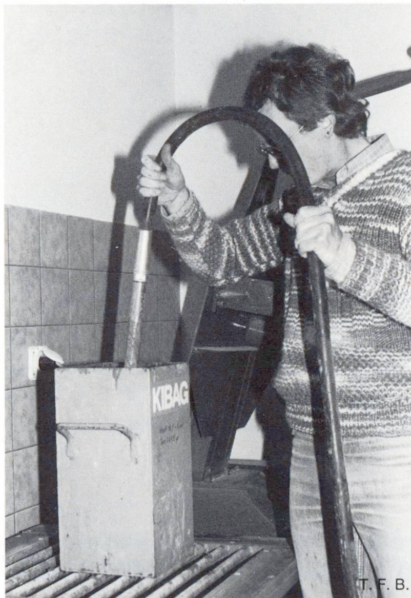
Verdichtungsmass: Verdichten der Probe
