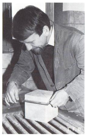
Ausmessen eines Probewürfels zur Volumenbestimmung
