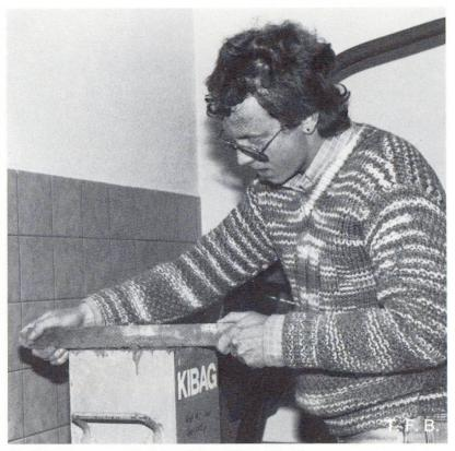
Verdichtungsmass: Abziehen des gefüllten Behälters
