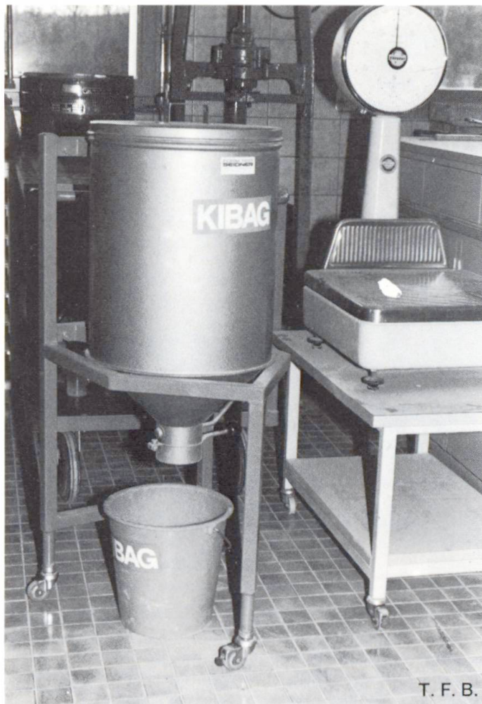
Laborsilo für Zuschlagsmaterial und Waage für Probemischungen
