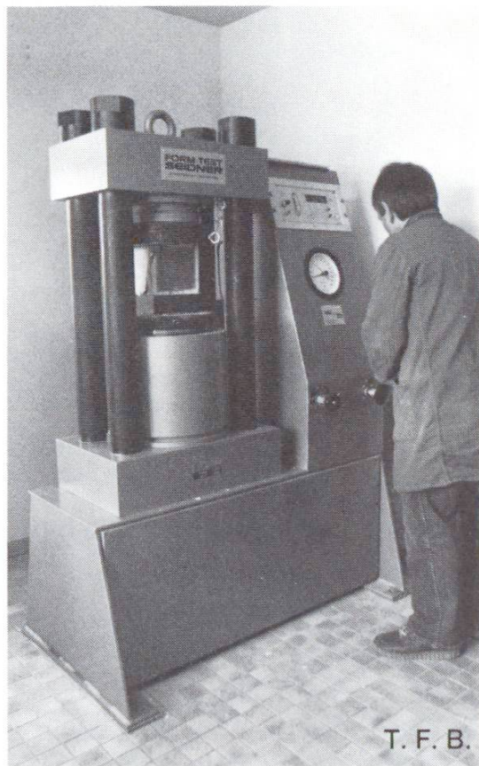
Bestimmung der Würfeldruckfestigkeit
