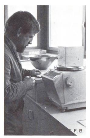
Bestimmung der Rohdichte des erhärteten Betons
