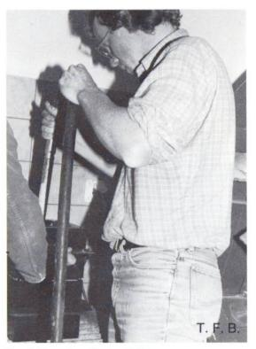
Verdichten eines Probewürfels
