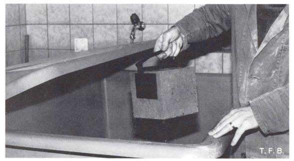
Wasserlagerung der Probewürfel vom 2. bis 21.Tag
