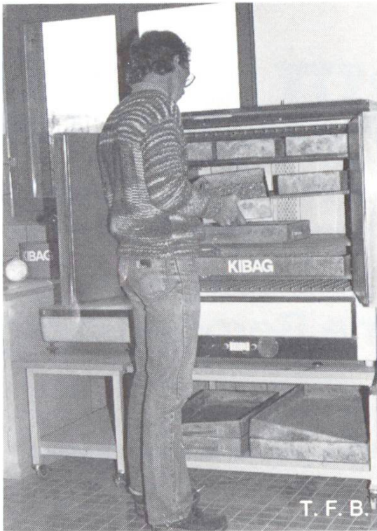
Trocknen von Zuschlagsproben vor dem Aus-sieben
