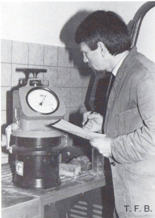
Bestimmung des Luftporengehaltes von LP-Frischbeton
