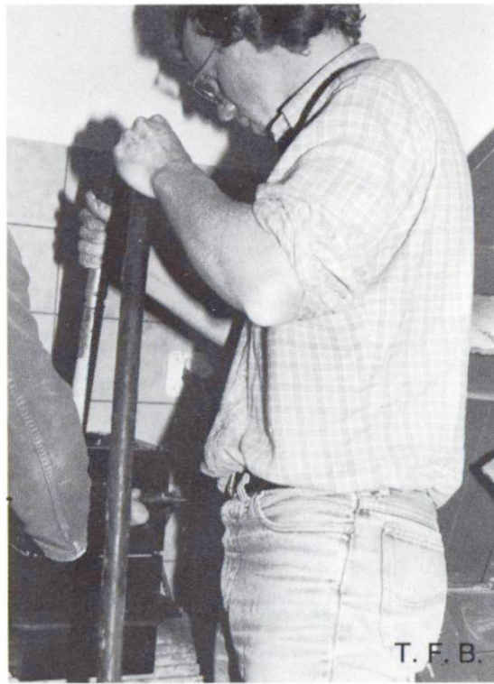
Verdichten eines Probewürfels
