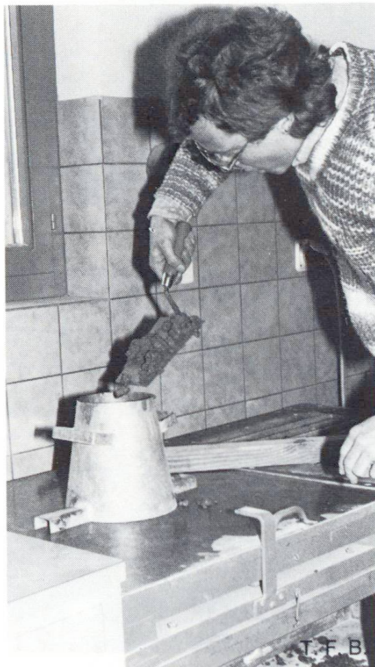
Ausbreitmass: Füllen des Konus
