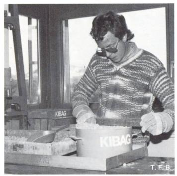
Bestimmung der Schüttdichte einer Zuschlagsprobe
