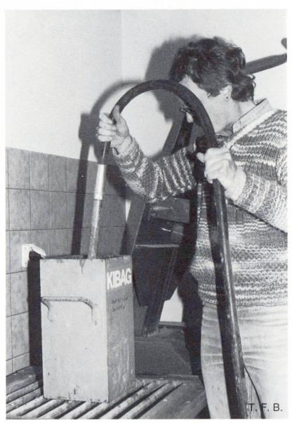
Verdichtungsmass: Verdichten der Probe
