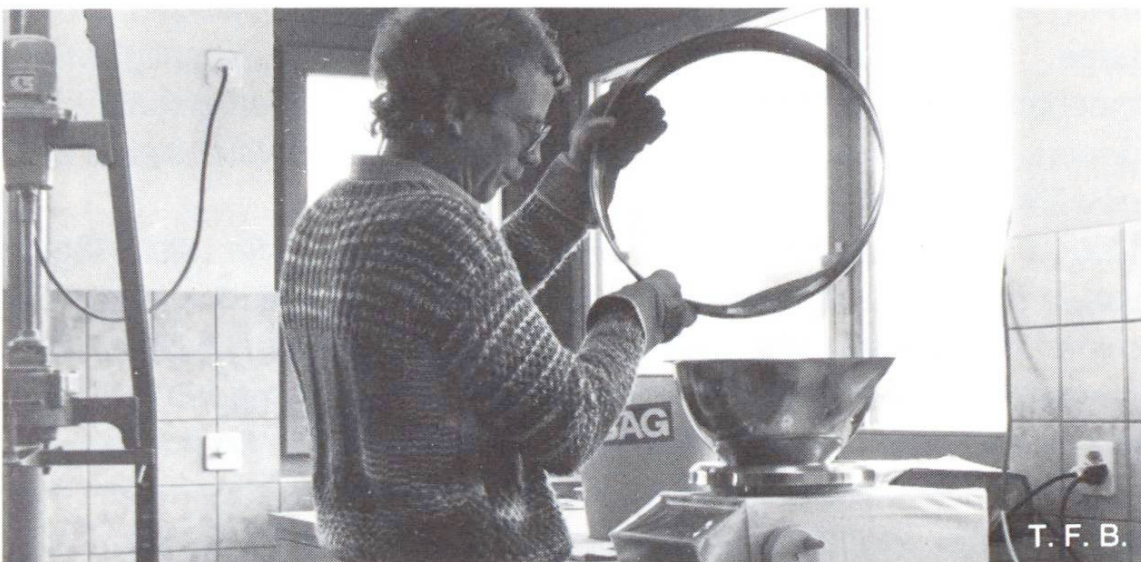
Auswägen einer Siebfraction
