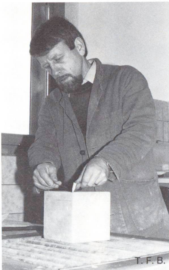
Prüfen der Auflagerflächen auf Ebenheit
