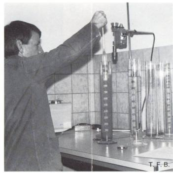
Schlämmanalyse zur Bestimmung von mehlfeinen Anteilen
