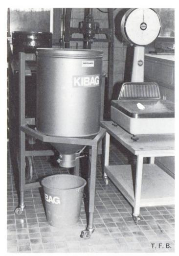
Laborsilo für Zuschlagsmaterial und Waage für Probemischungen
