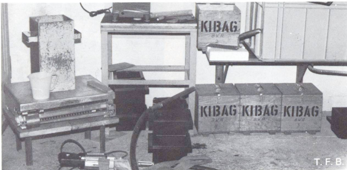
Blick ins Labor einer Betonzentrale mit Waage, Behälter für Verdichtungsmass, Würfelformen, Vibrator und Transportkisten für Probewürfel
