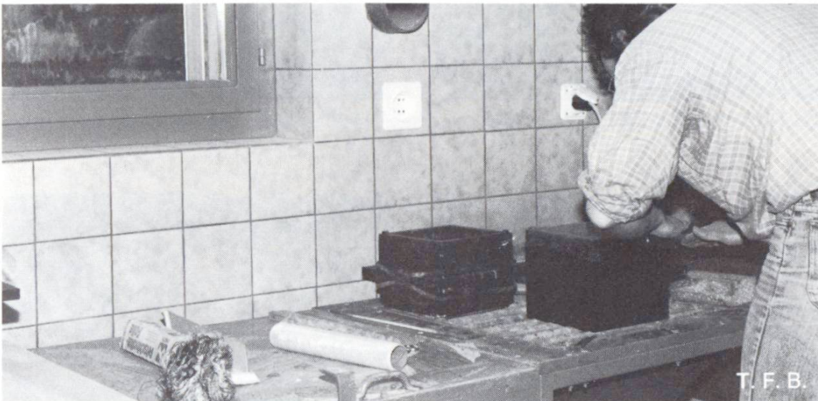
Fertigen eines Probewürfels in einer Plastikform
