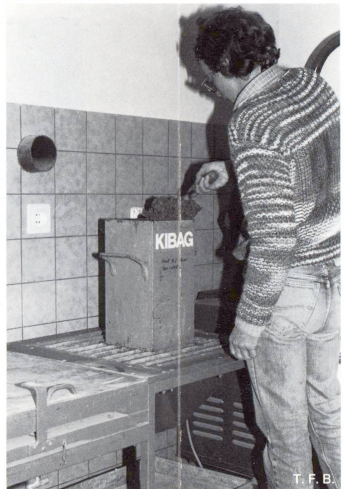
Verdichtungsmaß: Füllen des Normalbehälters
