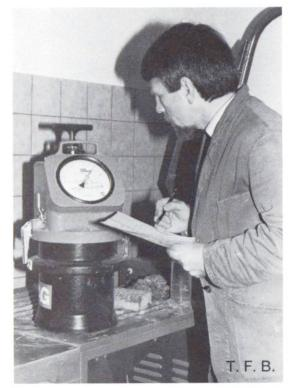
Bestimmung des Luftporengehaltes von LP-Frischbeton
