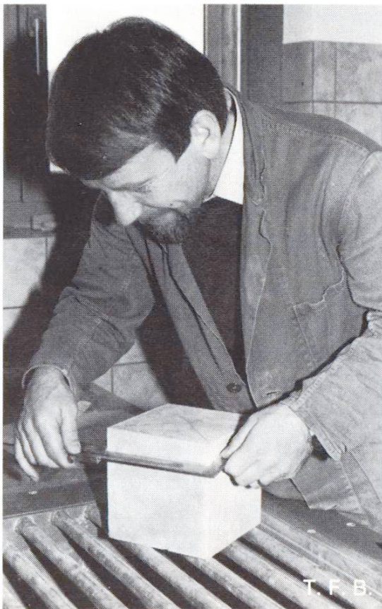
Ausmessen eines Probewürfels zur Volumenbestimmung
