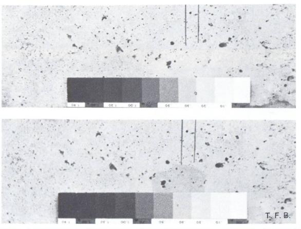
Abb. 4 Der schwach dunkle Flecken im unteren Bild wurde durch Abätzung von 1,8 mg Calciumkarbonat pro cm² erzeugt.
