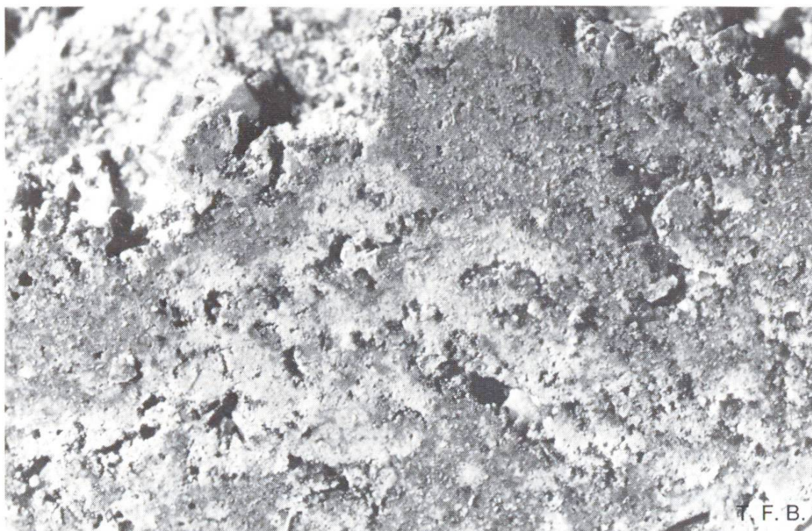
Abb. 1 Betonoberfläche aus glatter Schalung (vergrössert, die Bildbreite entspricht etwa 10 mm). Man erkennt helles und dunkles Zementgel, wobei das helle durch lokale Wasseranreicherungen entstanden ist. Die etwas glasig erscheinende Gelsubstanz lässt auch nichthydratisierte dunkle Zementteilchen durchschimmern. Ferner sieht man schwarze Löcher und weisse punktförmige Kalkausscheidungen, die zur Farbbildung beitragen.
