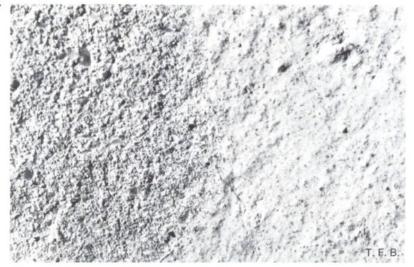
Abb. 5 Mikroskopische Aufnahme einer Abätzung von Kalk entsprechend Abb. 4. In der Betonoberfläche im linken Bildteil fehlen etwa 2 mg  $CaCO_3$  pro  $cm^2$ .
