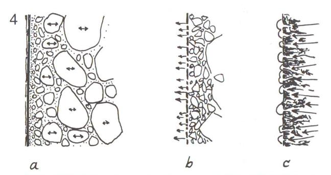
Abb. 2 a) Bei der Rüttelung schwingen grössere Körner weniger mit als kleine, leichte Partikel. Aus diesem Grund erfolgt eine Anreicherung von Wasser und Zement im Bereich einer harten und dichten Schalungsfläche.
