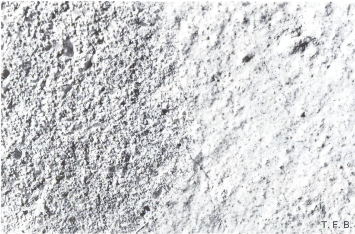
Abb. 5 Mikroskopische Aufnahme einer Abätzung von Kalk entsprechend Abb. 4. In der Betonoberfläche im linken Bildteil fehlen etwa 2 mg \text{CaCO}_3 pro \text{cm}^2 .
