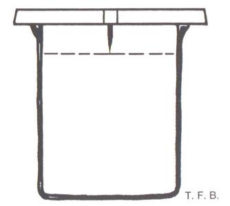
Abb. 2 Gewährleistung einer gleichbleibenden Wasserfüllung durch eine spitze Sonde, die durch ihre präzise Auflage auf dem Gefässrand stets eine eindeutige Lage erhält. Mit Hilfe der Spiegelung der Spitze im Wasser kann das Niveau der Wasseroberfläche genau eingestellt werden. Das Messgefäss muss waagrecht abgestellt sein.
