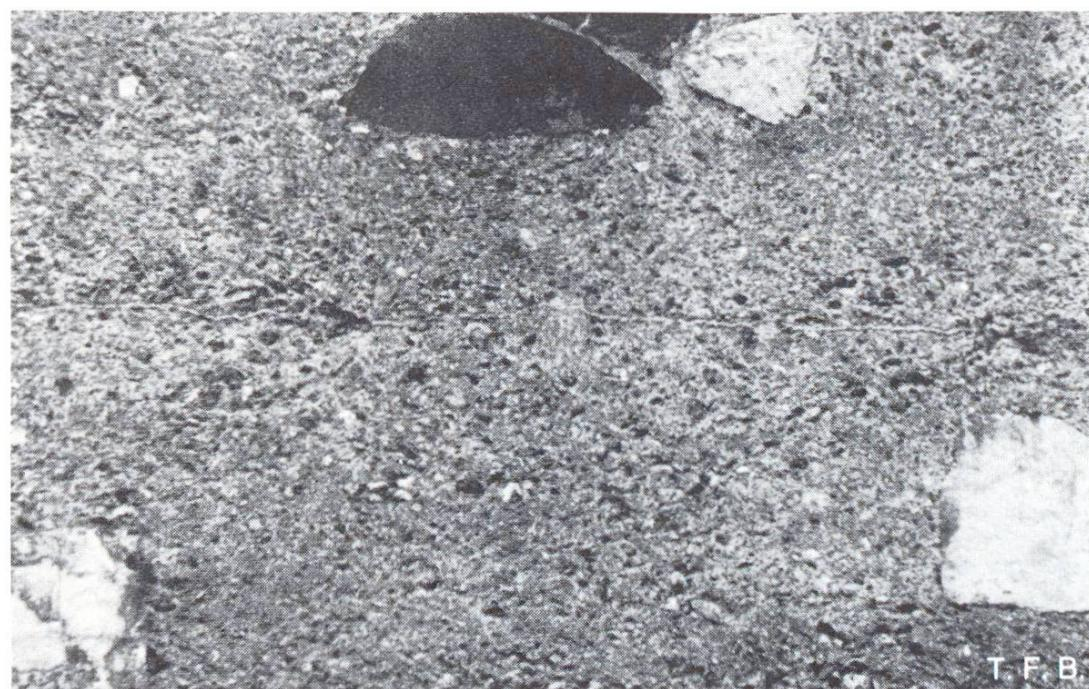
**Abb. 1 Beton aus roher Bretterschalung**
